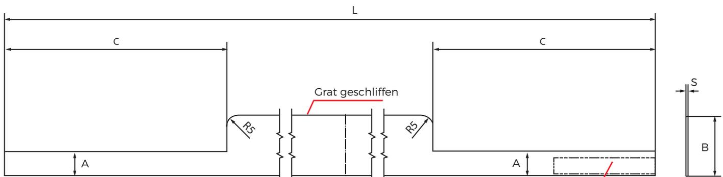
In diesem Bereich wird die Klingenhöhe in mm angegeben: Mass B
